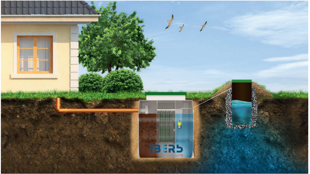
При высоком уровне грунтовых вод с насосным отсеком в альпийскую горку
